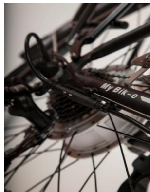
Μοτέρ οπίσθιο BAFANG 250W Μπαταρία λιθίου PHYLION 36V 13Ah
